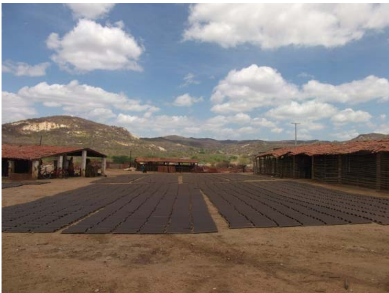
Figura 4.32: Secagem natural de telha em pátio na região Seridó.
