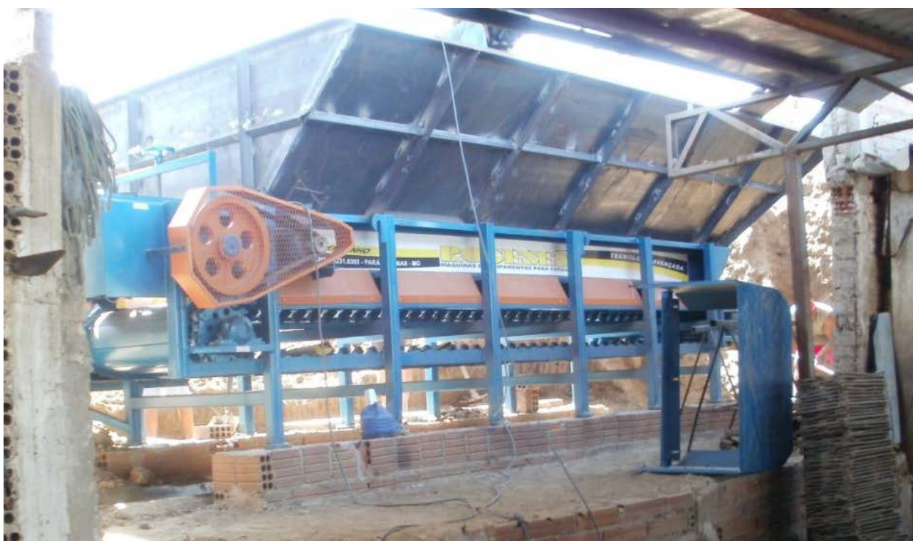
Figura 4.26: Caixaão alimentado automático sendo instalado em cerâmica da cidade de Parelhas/RN na Região Seridó.
