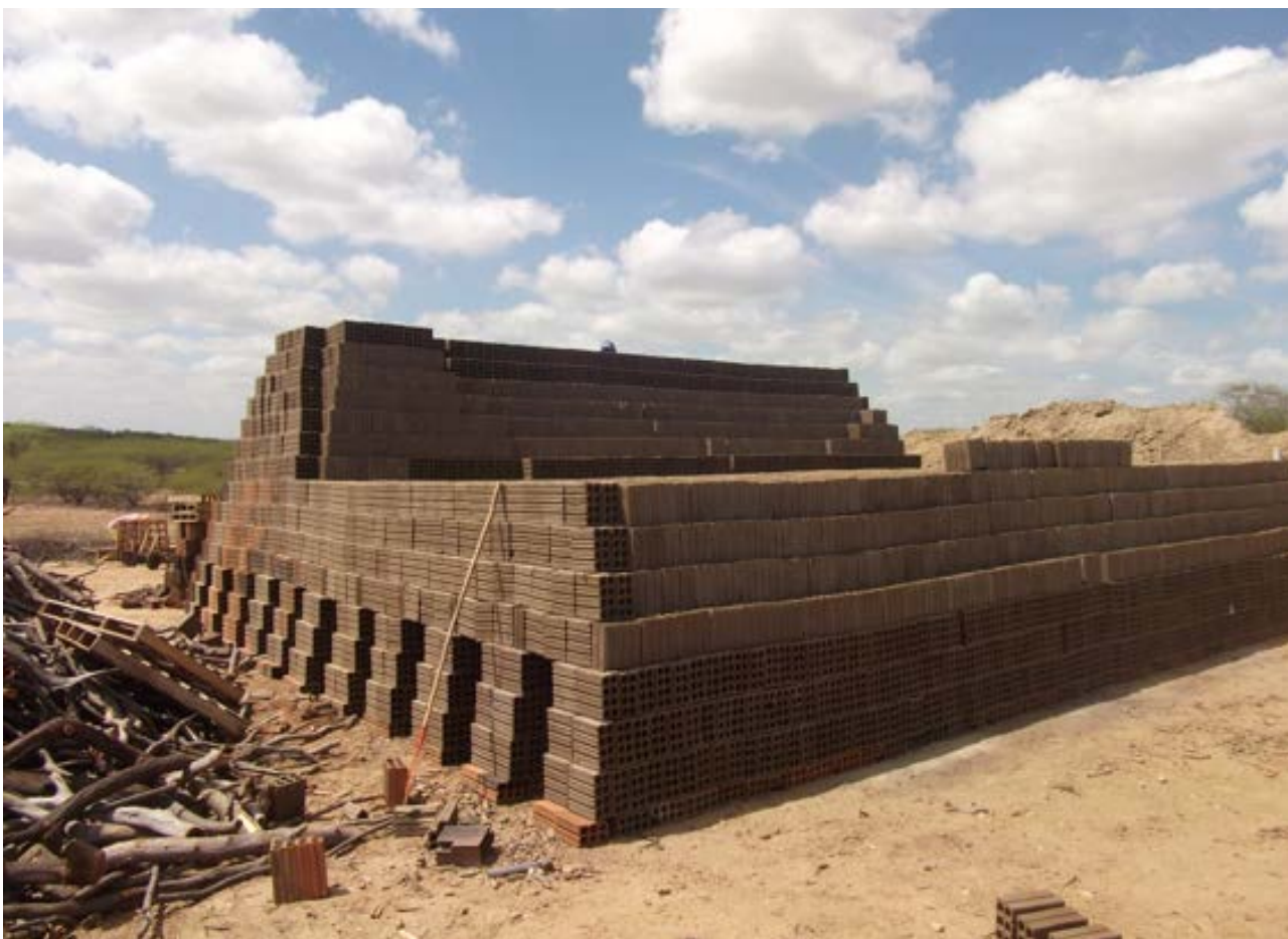
Figura 4.42: Caieira sendo montada para queima de bloco de vedação na Região Seridó – sistema mais primitivo (Foto: autor).
