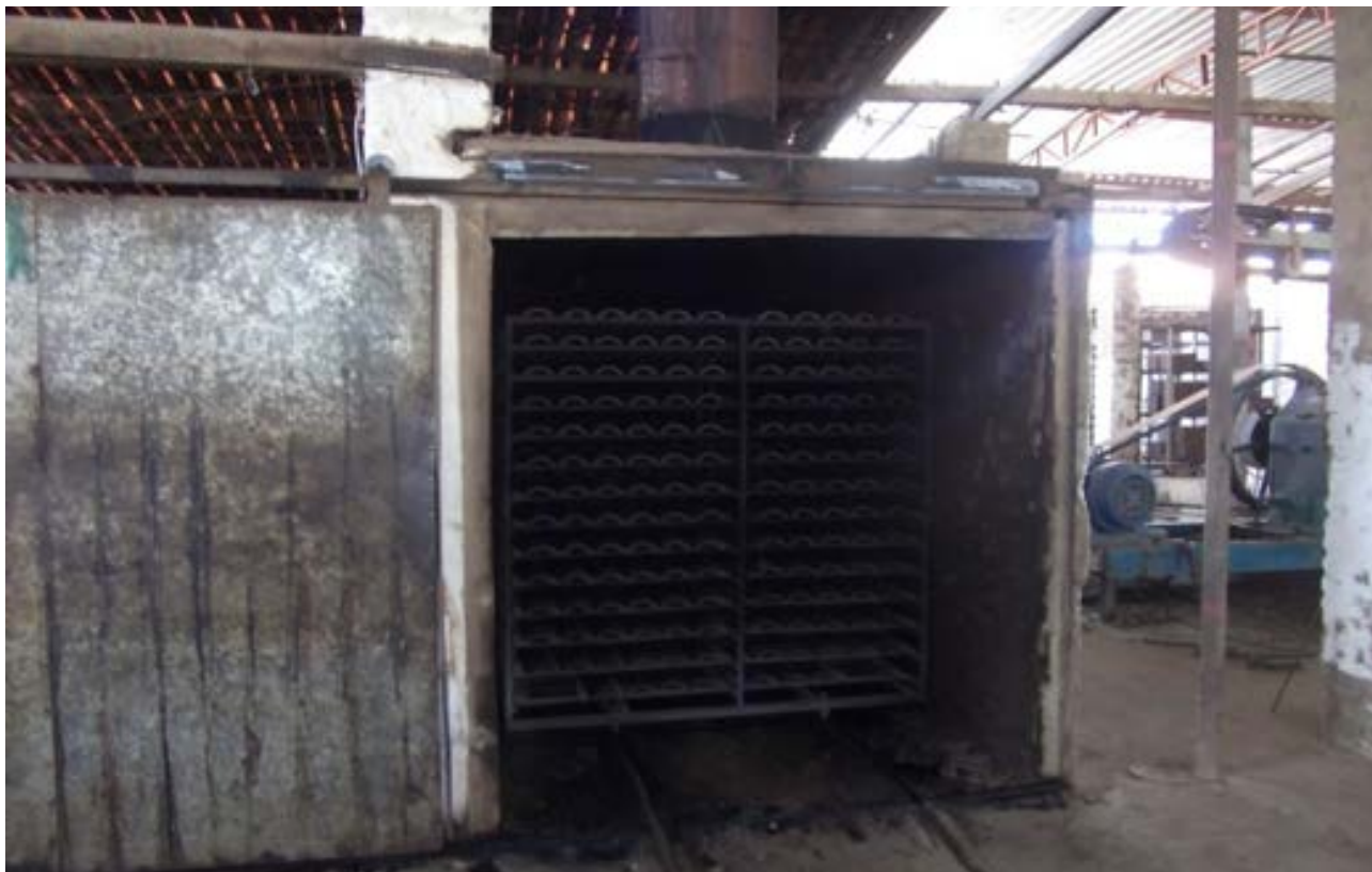
Figura 4.35: Secagem Forçada de telhas em secador tipo túnel em Currais Novos/RN.
