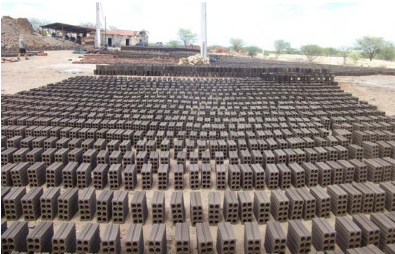
Figura 4.33: Secagem natural de bloco de vedação (tijolo 9cmx19cmx19cm) em pátio na região Seridó.
